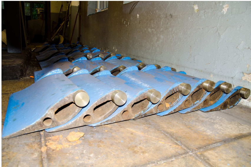
Obr. 19: Lopatky osazené novými čepy (zdroj: autor)
