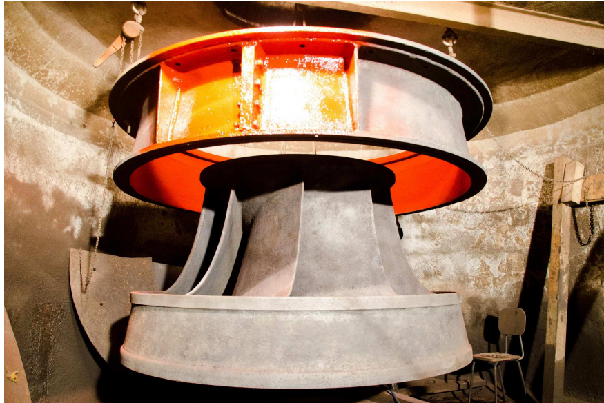
Obr. 23: TG2 po opískování (zdroj: autor)
