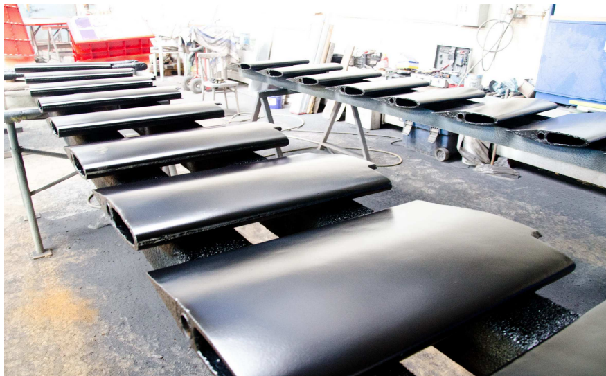
Obr. 24: Lopatky TG2 po povrchové úpravě (zdroj: autor)
