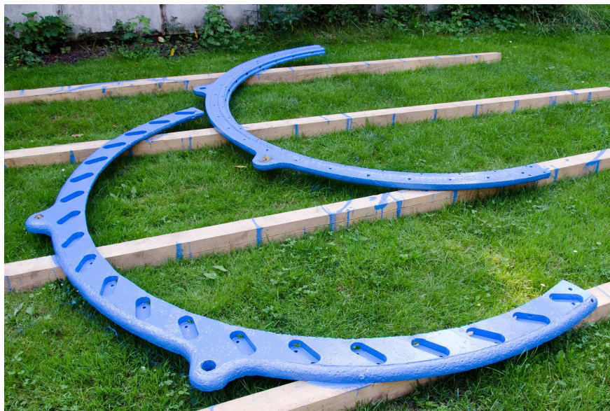
Obr. 20: Rozváděcí kruh TG1 (zdroj: autor)
