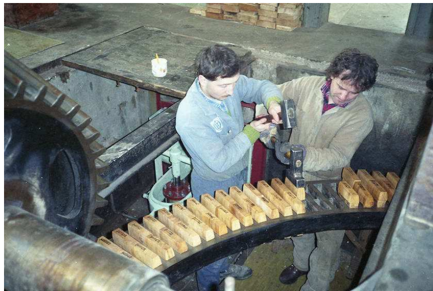
Obr. 9: Osazování palečného kola habrovými zuby (zdroj: fotodokumentace majitele)
