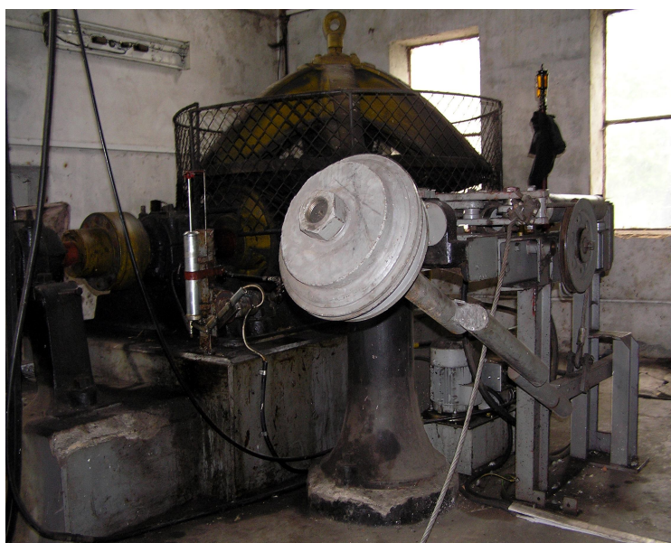
obrázek 5.2.4-1 zvonové kolo a regulace rozváděcích lopatek[4]
