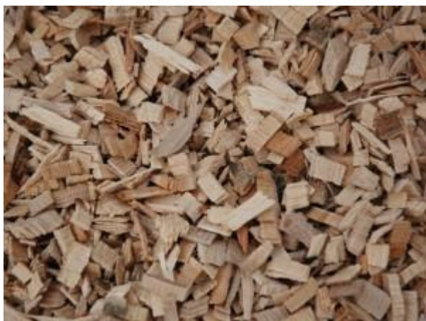
Obr. 16. Dřevní štěrka vyrobená nožovým štěpkovačem [5]
