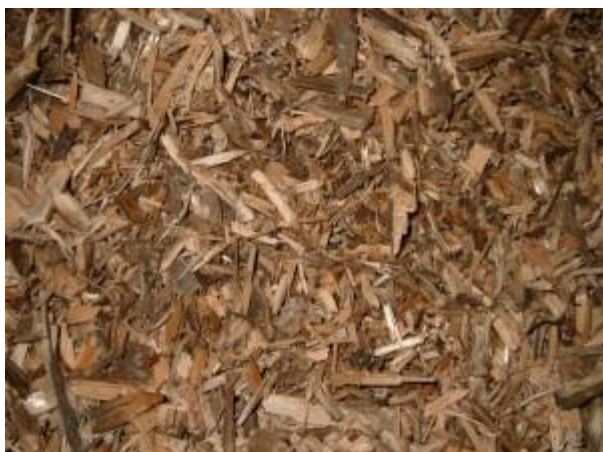
Obr. 17. Dřevní štěrpkou vyrobená kladivovým drtičem [5]
