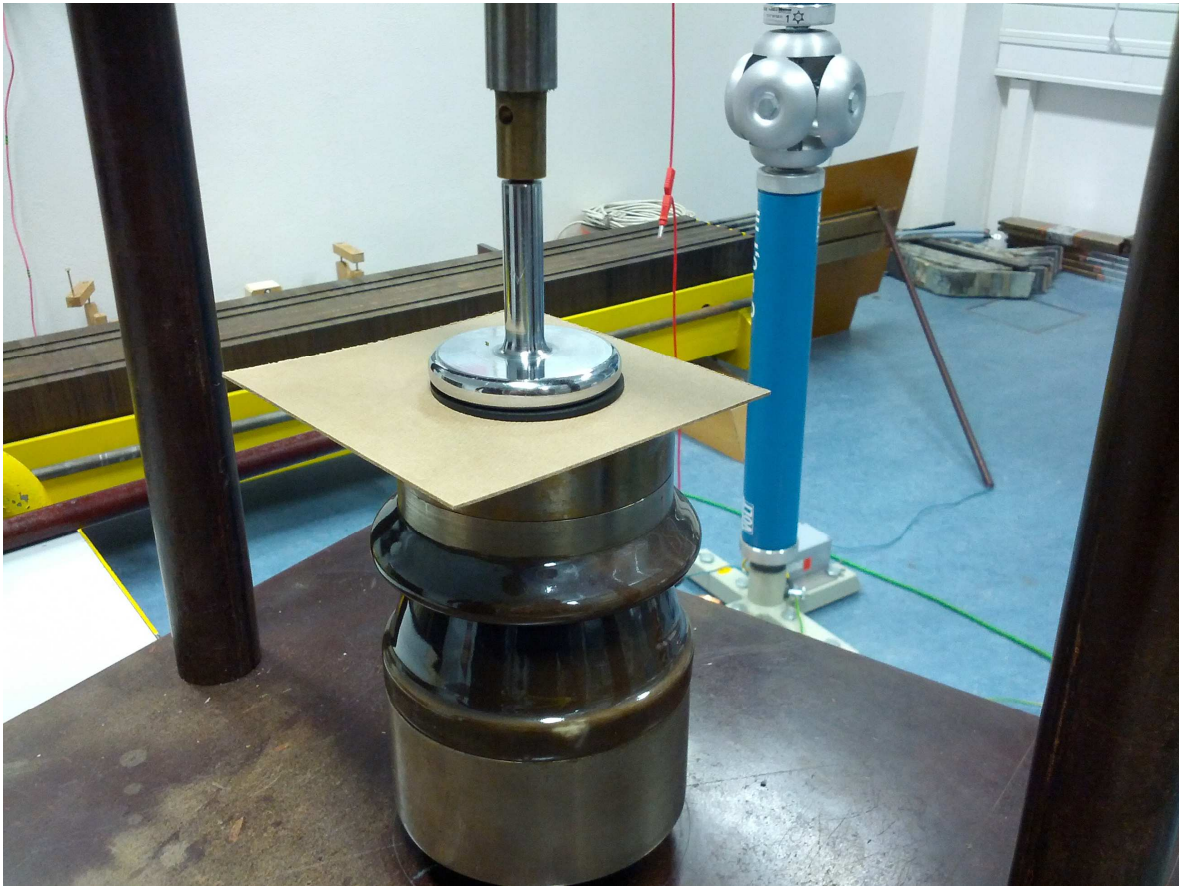
Obr. 41 Měření vzorek kartitu s přiloženými měřicími elektrodami
