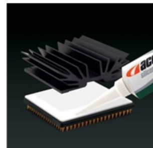
Obr. 18 Použití tepelně vodivého silikonu [24]
