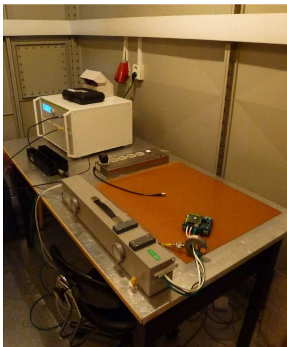
Obrázek 18: Kontrolní měření testovaného zařízení dle normy ČSN EN 61000-4-6
