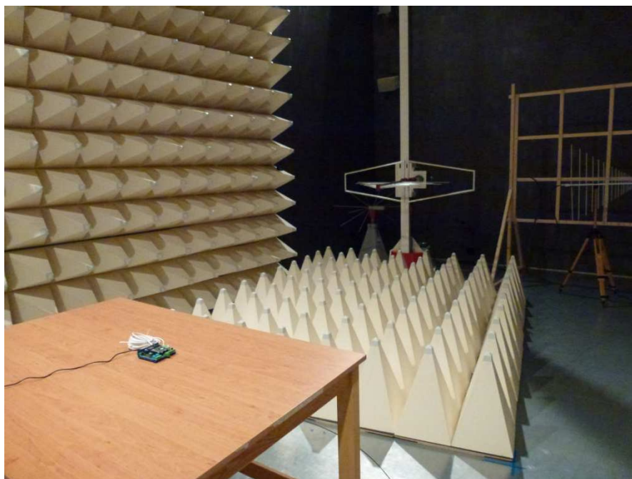
Obrázek 9: Měření v bezodrazové komoře
