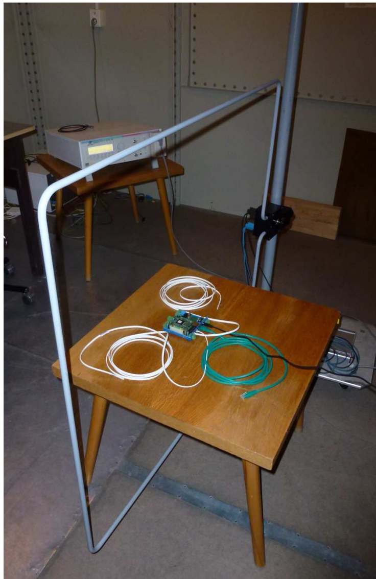
Obrázek 27: Průběh zkoušky odolnosti dle normy ČSN EN 61000-4-8
