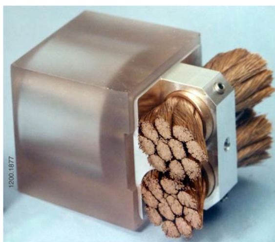
Obrázek 4.4: Projektil s kartáči a lexanovou hlavicí. [Převzato z [11]]
