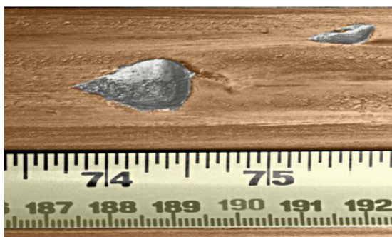
Obrázek 5.1: Gouging (prohlubně ve tvaru kapek). [Převzato z [11]]
