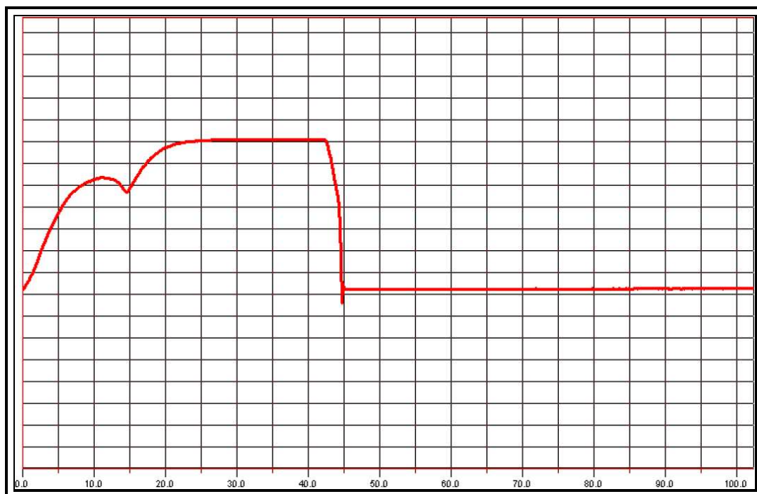
Obr. 13 – Křivka proudu protékajícího ovládací cívkou při operaci ZAP
