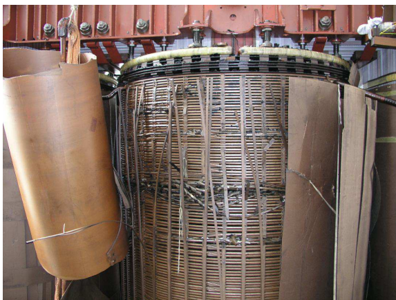
Obr. 8 Poškozené vinutí transformátoru a jeho detail po rozebrání [13]
