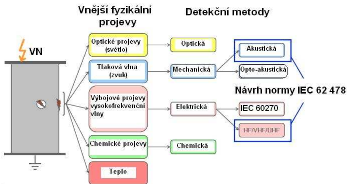
Obr. 9 Principy detekce částečných výbojů [30]
