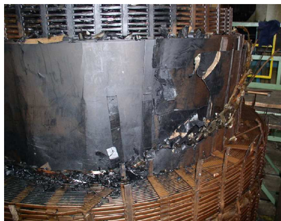
Obr. 8 Poškozené vinutí transformátoru a jeho detail po rozebrání [13]
