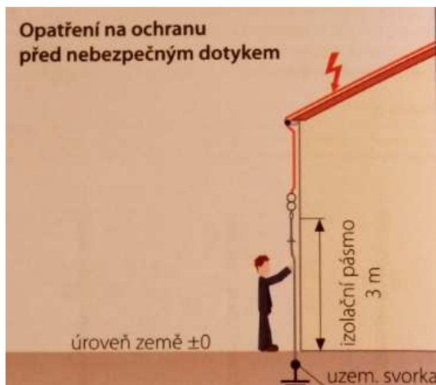
Obr. 35 Izolační pásmo u vysokonapět'ových HVI a CUI kabelů [14]
