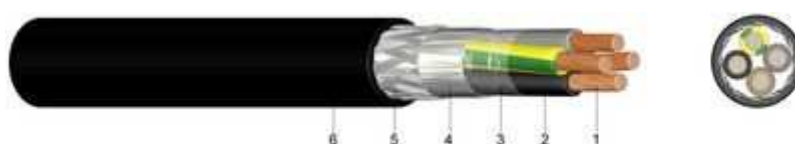
Obr. č. 2: Vodič 2YSLCYK pro připojení motorů [15]
