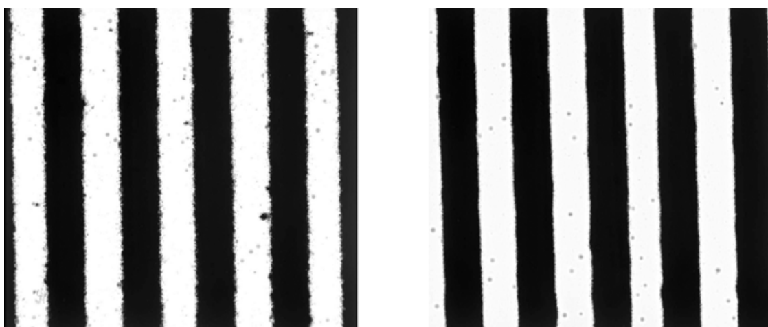
Obrázek 1. Příklad 20 mikronových čar / mezer [15]
