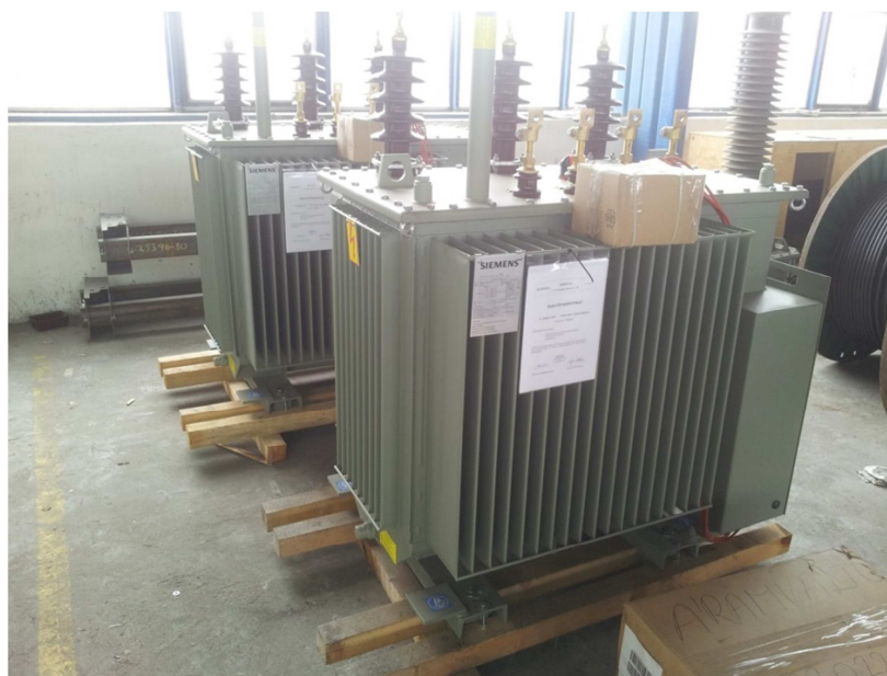
Obr. 5.8 Distribuční transformátor SIEMENS s regulací pod zatížením [19]
