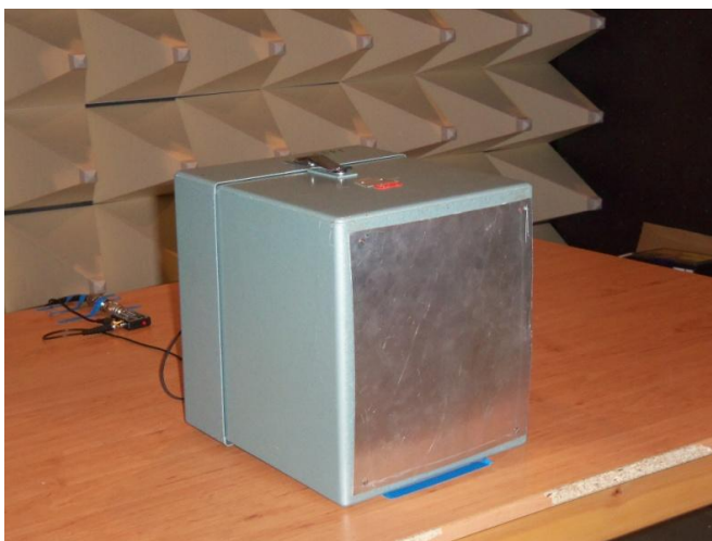
Obr. A.3 – Stínící kryt s plnou hliníkovou náhradní deskou
