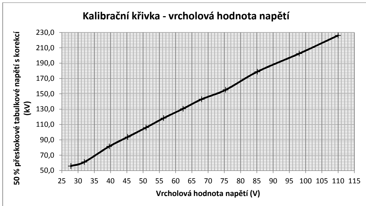
Obrázek 41: Kalibrační křivka 50% přeskokového tabulkového vrcholového napětí v závislosti na výstupním vrcholovém napětí generátoru
