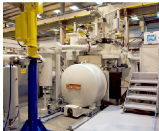
Obr. 3. 12 Indukční vakuová pec pro přesné lití [16]
