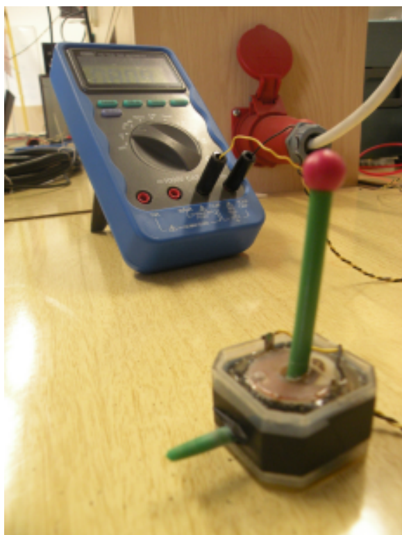
Obr. 9 Měřicí cívka a měřicí přístroj FINEST 703 TRUE RMS multimeter
