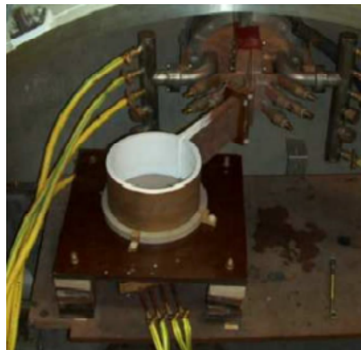
Obr. 3. 9 Studený kelímek v jednozávitovém provedení v reálu [14]
