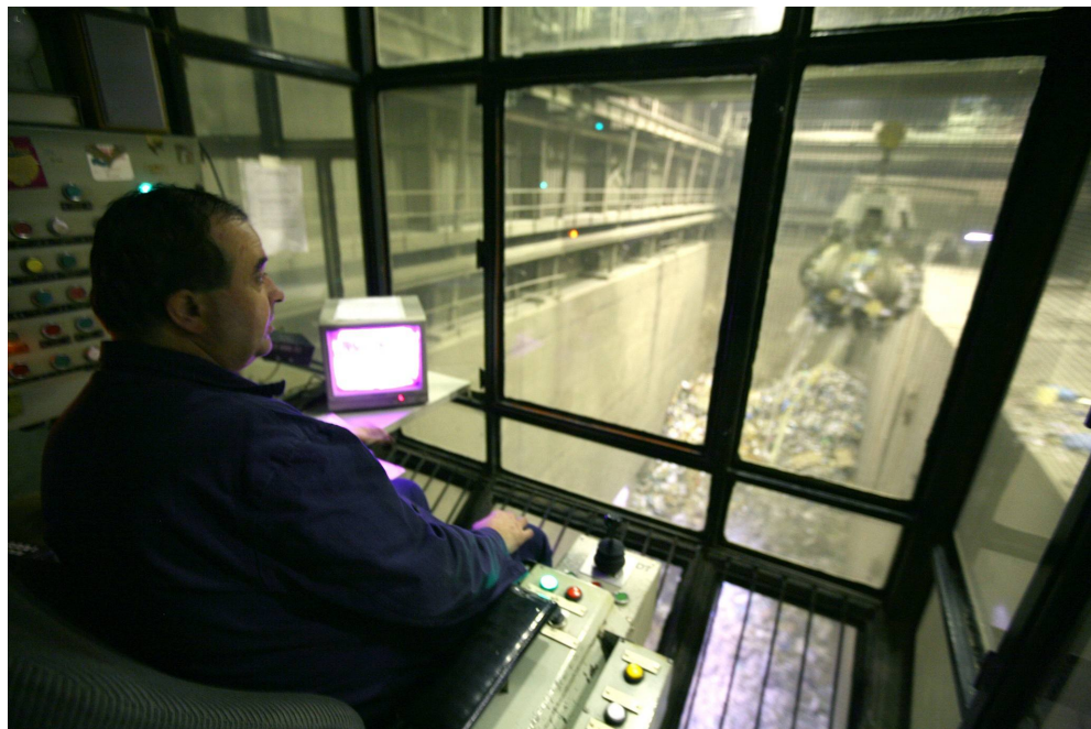
Obr. č. 3 Pohled do bunkr odpadu z kabiny jeřábu Spalovna SAKO Brno [13]
