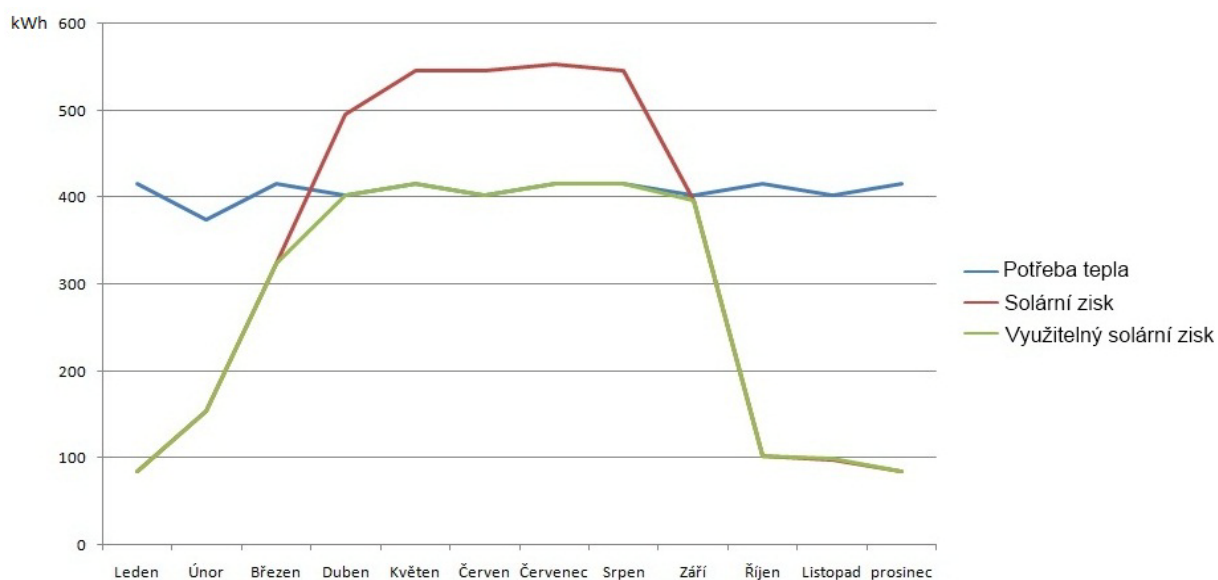
Graf 4.2 Tepelná bilance solárního systému
