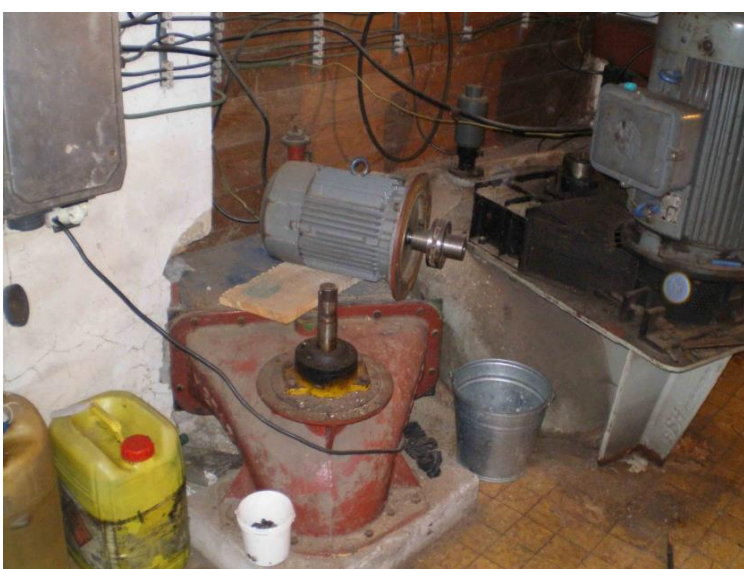
Obrázek 13 Rozebraná turbína MT3
