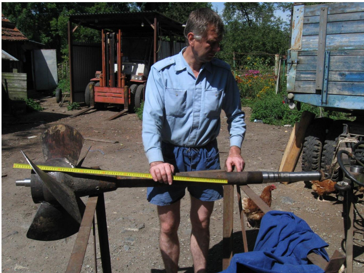
Obrázek 16 Vymontovaná hřídel i s vrtulí
