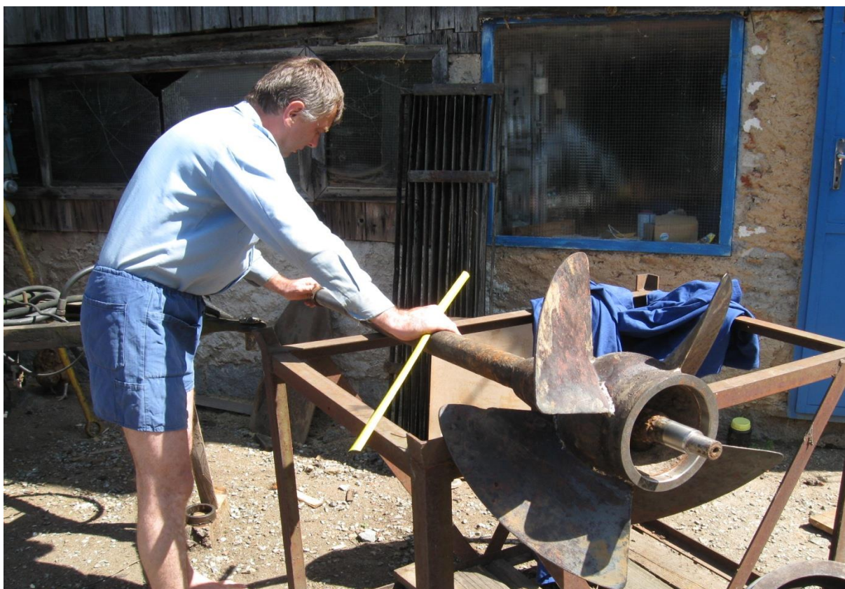
Obrázek 17 Vymontovaná hřídel i s vrtulí - detail
