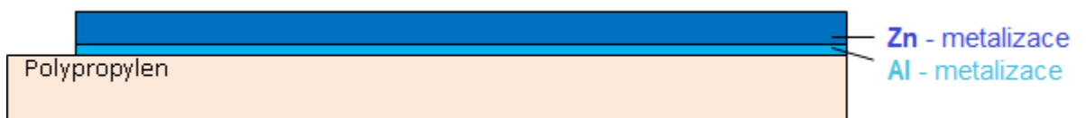
Obr. 7: Řez pokovenou polypropylenovou fólií (MKP)
