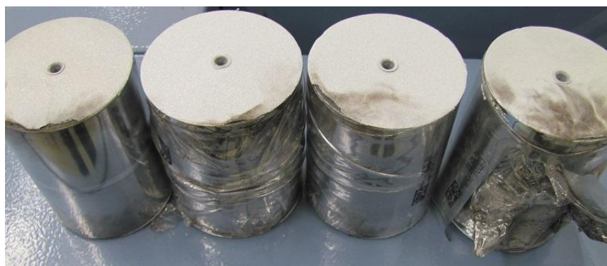
Obr. 21: Svitky po přeskoku v posledních závitech aktivní fólie
