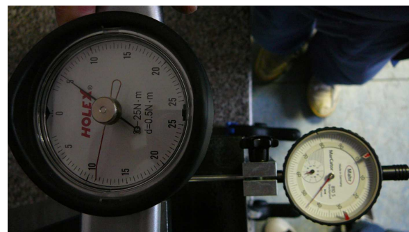
Obr. 17 zatížení hřídele momentem -5 Nm
