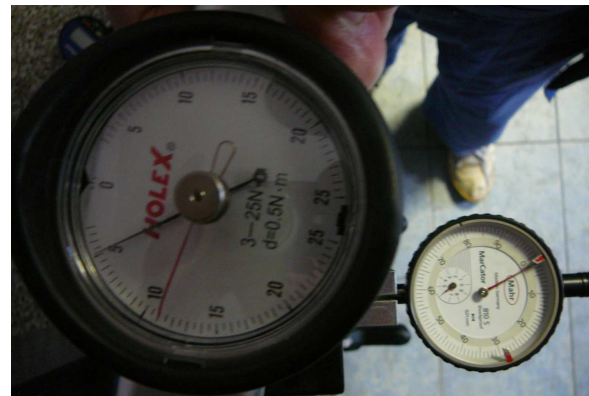
Obr. 16 zatížení hřídele momentem +5 Nm
