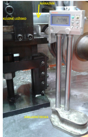
Obrázek 5.23 Měření výškového nastavení kluzného ložiska
