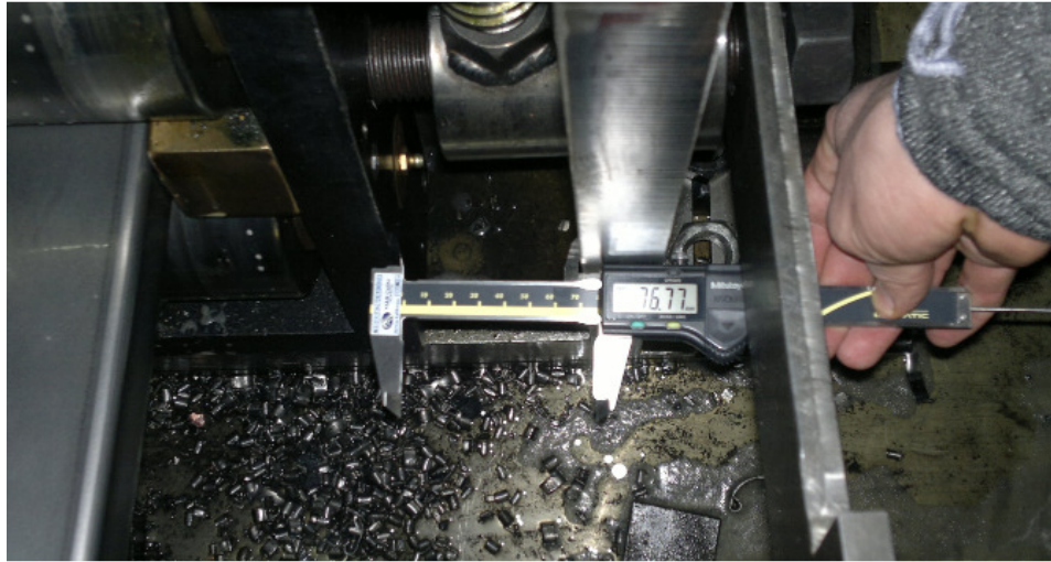
Obrázek 5.11 - Měření nastavení Sweep bloku pomocí posuvného měřidla
