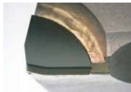
Obrázek 2-19Úprava řezné hrany na PKD [12]
