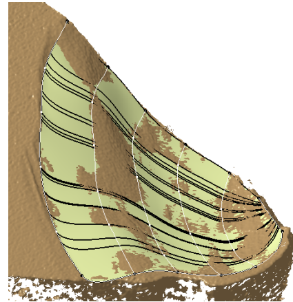
Obrázek 4-6 Rekonstrukce opotřebovaného čela
