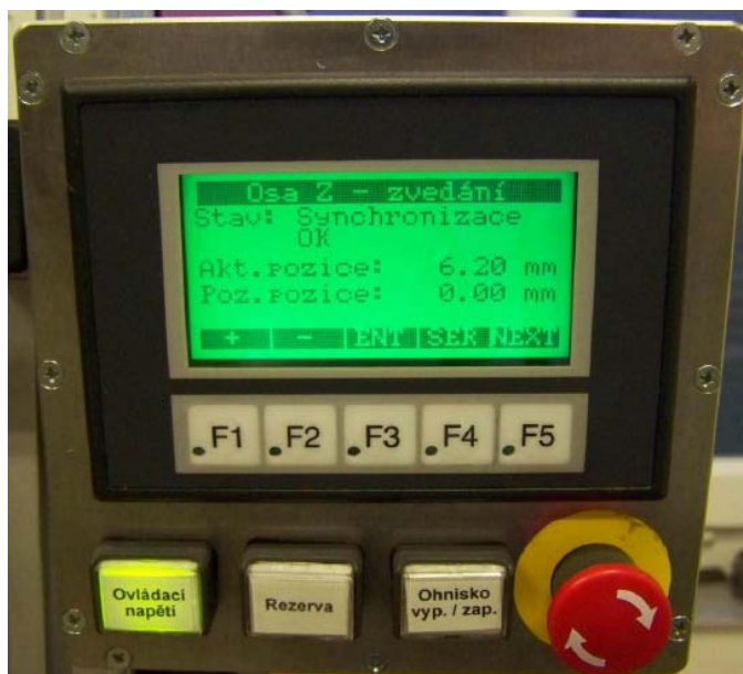
Obrázek 3-4 Nastavení výšky pomocí PLC panelu
