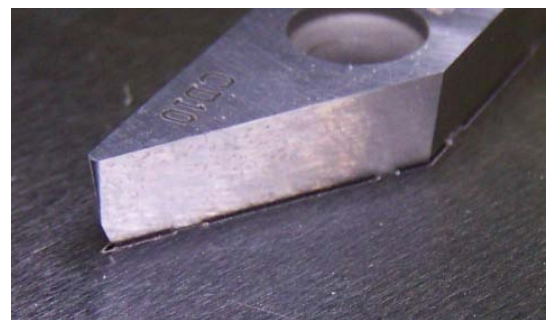
Obrázek 3-27 Přesné uložení fyzické VBD v přípravku
