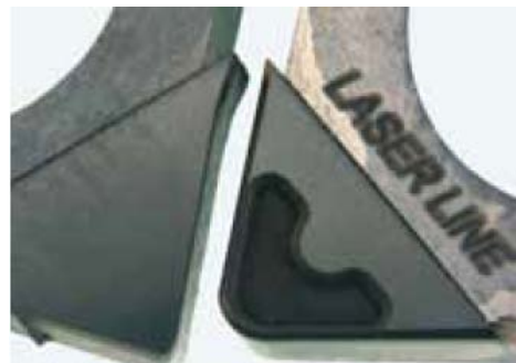
Obrázek 2-5 úprava VBD z PKD na jedno upnutí (vlevo: před/ vpravo/po úpravě) [12]
