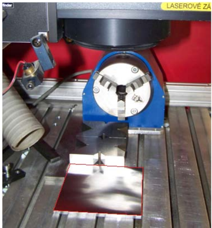
Obrázek 3-22 Uložení přípravku v pracovním prostoru laseru
