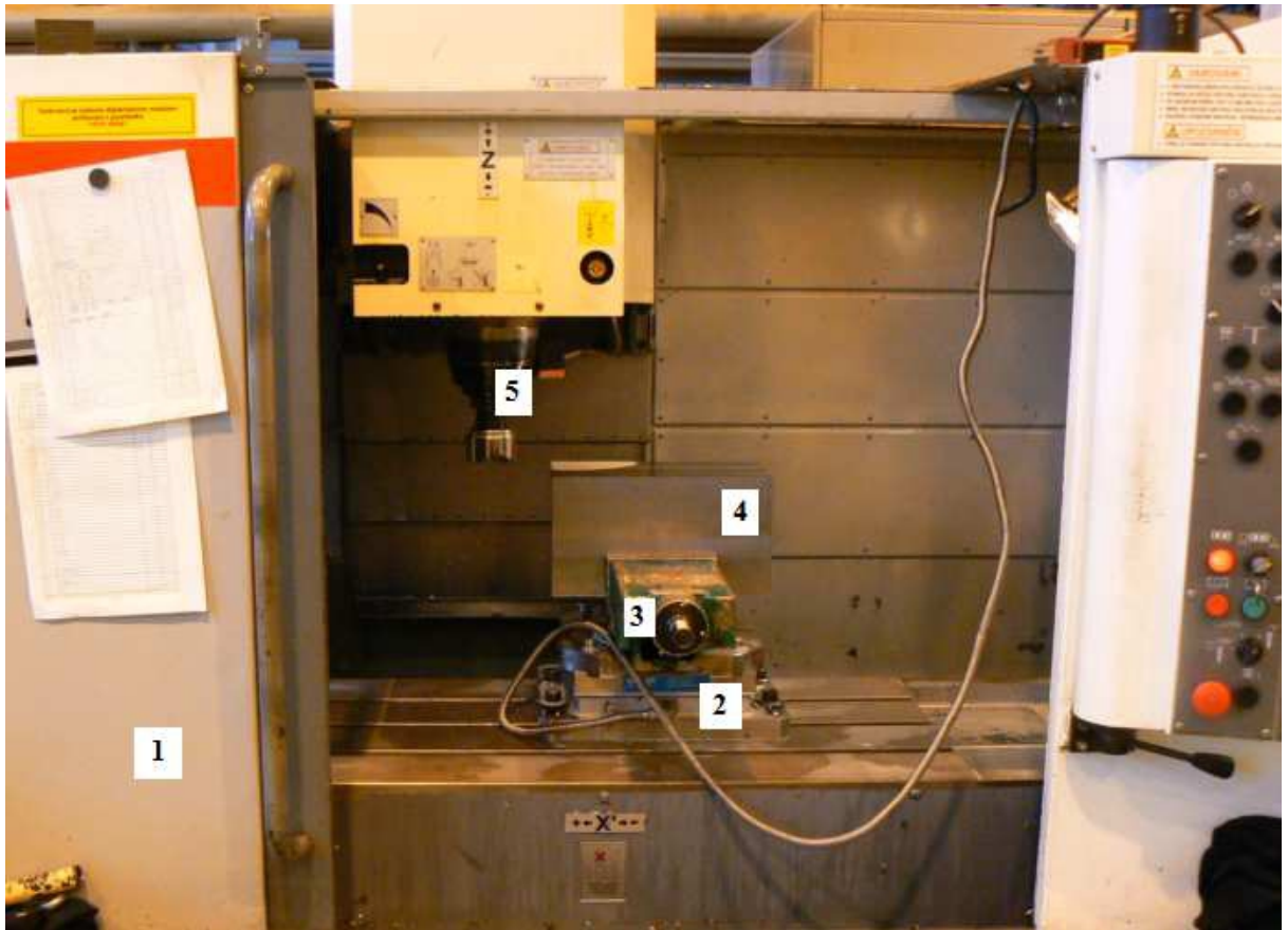
Obr. 3.9. Nastavení experimentu; 1- obráběcí centrum MCV 750A, 2- dynamometr Kistler, 3- strojní svěrák, 4- obrobek, 5- nástrojová hlava s VBD.
