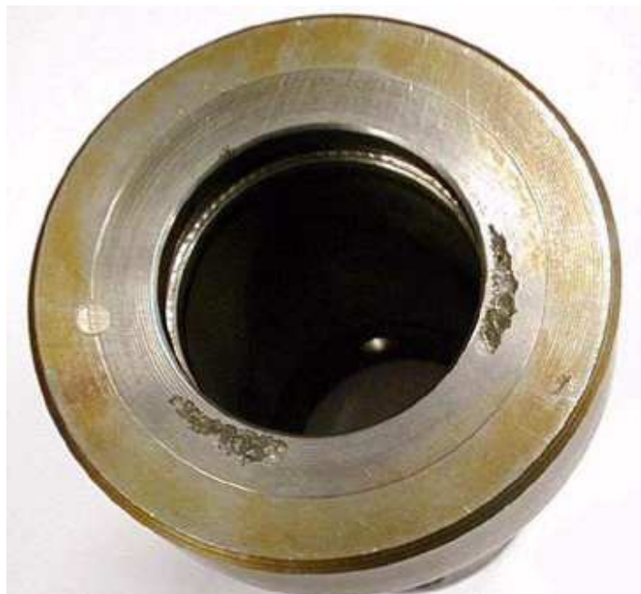
Obr. 2.7. Ukázka štěrbinové koroze příruby z nerezové oceli, [9].
