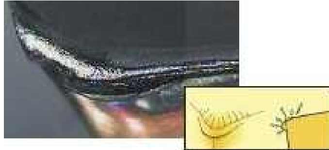
Obr. 2.18. Ukázka plastické deformace nástroje, [20].
