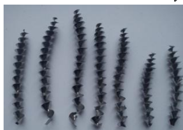
Obrázek 45: Porovnání velikosti šroubovitých třísek
