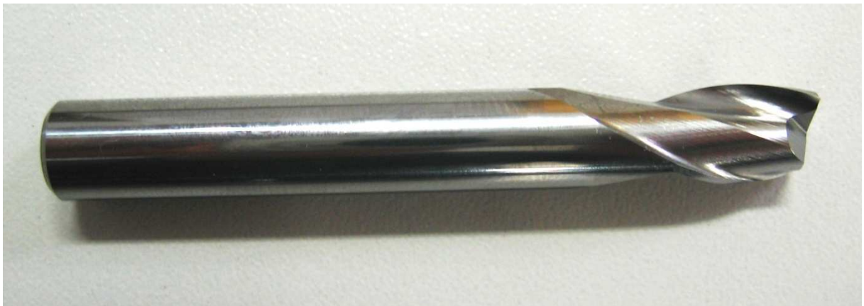
Obrázek 5-7: dvoubřitá monolitní fréza z SK D=8\text{mm}
