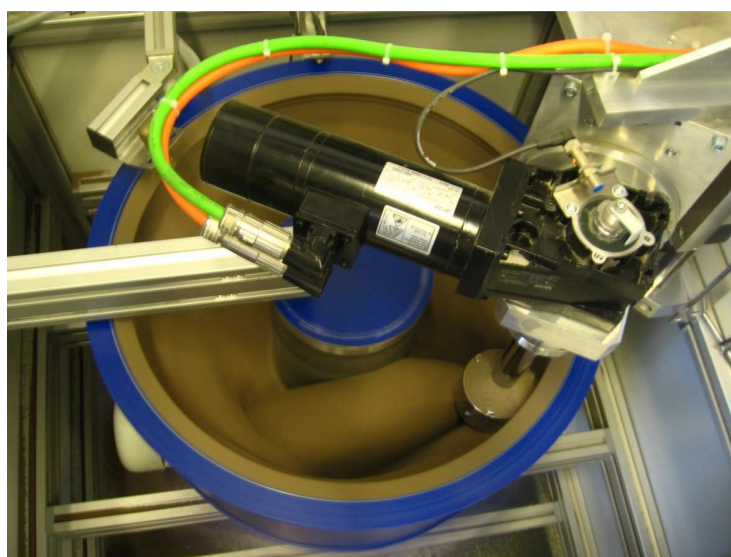
Obrázek 5-4: proudové omílací zařízení SF 1/1-68 v chodu
