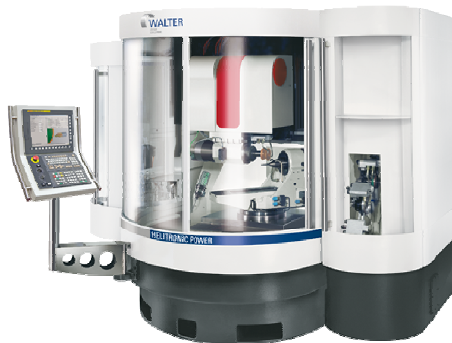
Obrázek 2-4: CNC nástrojařská bruska Walter Helitronic [26]
