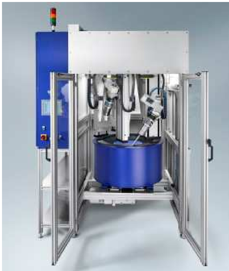
Obrázek 2-12: stroj OTEC pro proudové omílání [24]
