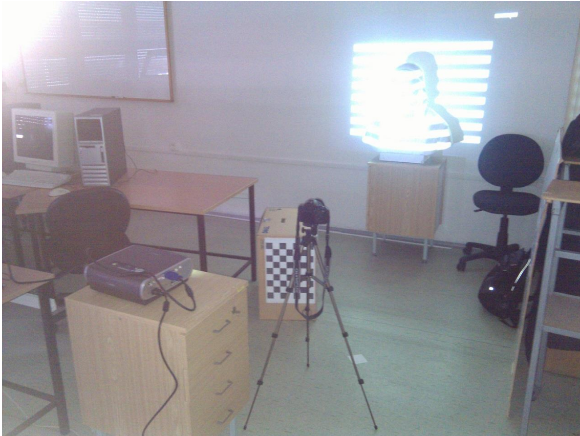
Fig. 2.8: Pohled na soustavu jak promítá vzor na objekt
