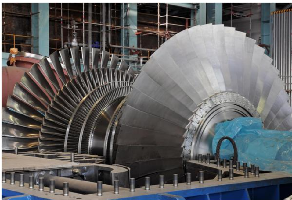
Obrázek 1-1: Parní turbína tepelné elektrárny Tušimice [1]
