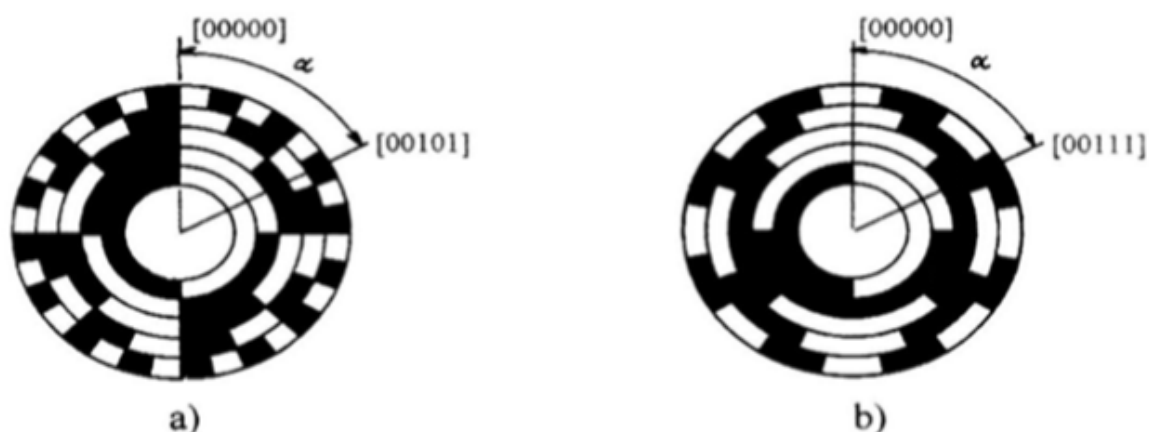
Obrázek 2.14: Kódové kotoučky: a) binární kód, b) Grayův kód (převzato z [24])
