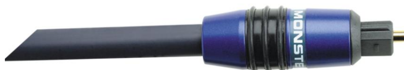
Obr. 2.1 Optický kabel zakončený konektorem Toslink [35]
