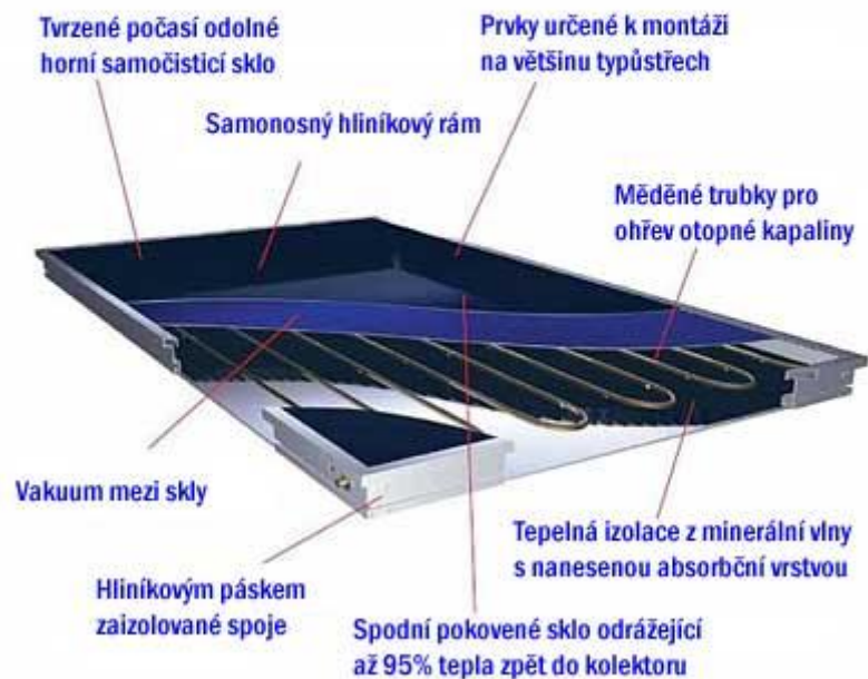
Obrázek 4 Princip solárního vakuového deskového kolektoru[12]
