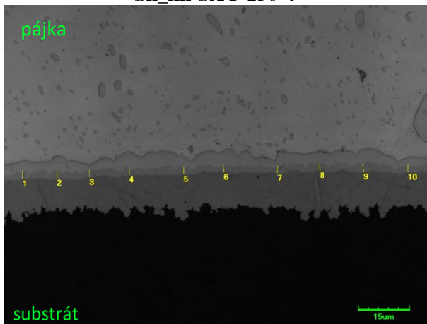
Obrázek 196: Řez testovaného vzorku Sn_im-SAC-150-32
