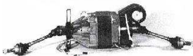
obr. 3-2 Pohonná jednotka se stálým převodem od firmy Leroy Sommer 13
