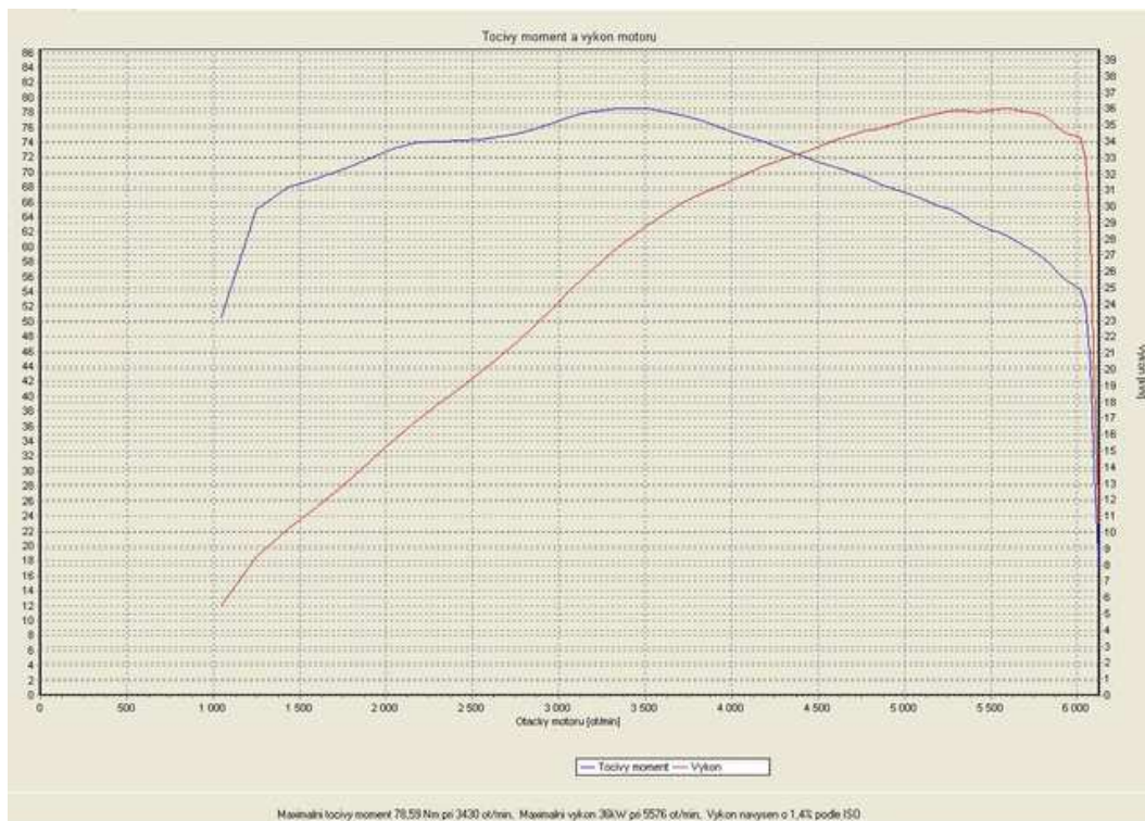
graf 2-A naměřené hodnoty výkonu a točivého momentu vozidla Peugeot 106 1.0
