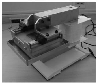
FIG.3.: EXPERIMENTAL LINEAR ELECTROMECHANICAL ACTUATOR
