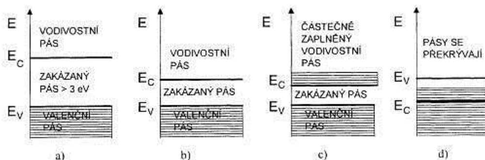
Obr. 5 Pásový model pevných látek [2]
