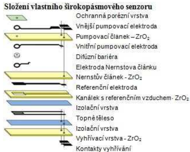
Obr.: 14-Složení vlastního senzoru širokopásmové sondy [8]
