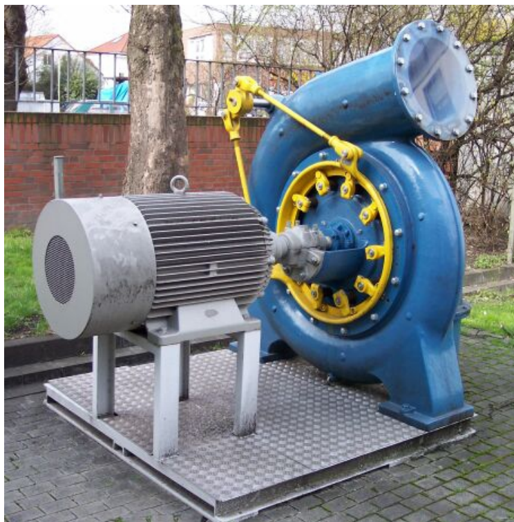
Obr 1.2 Francisova turbína s generátorem [20]
