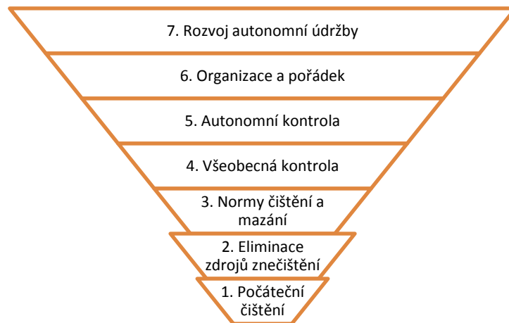
Obrázek 9-3 7 kroků k zavedení autonomní údržby
