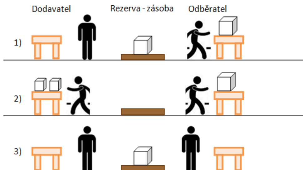
Obrázek 7-5 Kanban řízený vizuálními signály (obrázek byl inspirován ilustrací v [26 str. 16] )
