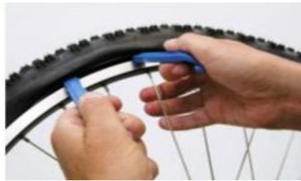
Obrázek 9-4 Oprava části zařízení - zde výměna duše jízdního kola [32]
