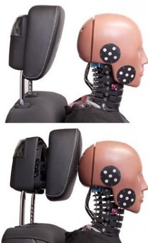
Obr. 3-10 Aktivní opěrka hlavy
