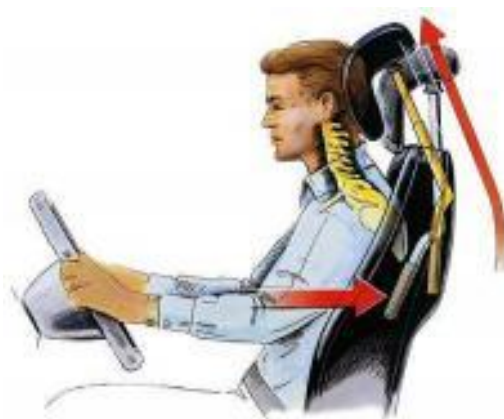
Obr. 3-20 Reaktivní opěrka hlavy [9]
