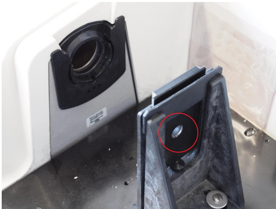
Obr. 8 Nástavec pro měření spektrální závislosti transmitance (v označeném místě se nachází měřený vzorek)
