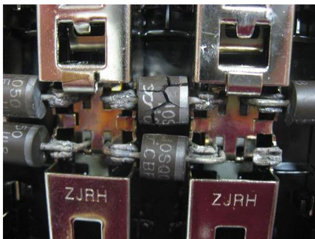
Obr. 3.14 Proražení bypassové diody [18]
