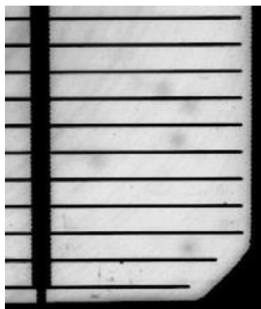
Obr. 3.7 Prachové částice zatavené v článku [13]
