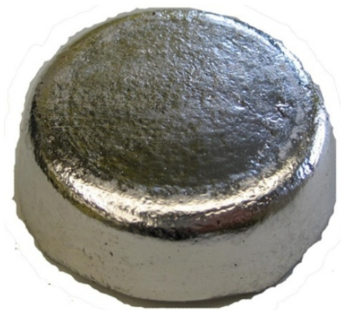
Obr. I.1 Ingot Fieldova kovu před tavením – 1 tableta [ 37 ]
