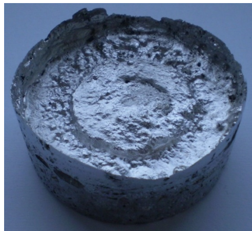
Obr. I.2 Ingot Fieldova kovu po tavení – 3 tablety
