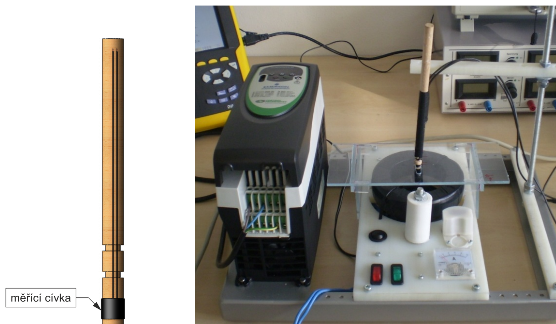
Obr. 4.1 Měření magnetického pole induktoru
