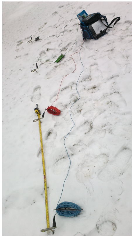
Obr. 2.5 Měření měrného odporu půdy pomocí přístroje Metrel Mi2124
