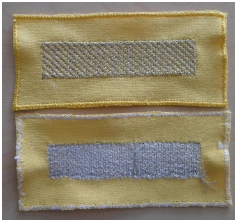
Obr. 5.3 Ukázka textilní elektrody ELITEX ® o rozměrech 80 x 20 mm.
