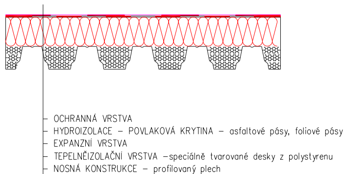
obr 3.09 Jednoplášťová plochá střecha z plechu (trapézový) – trapézový plechy vyplněn formovanou izolací, s úpravou plechů, která slouží jako parozábrana
