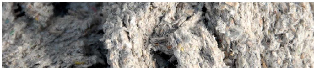
( obr. 2.5.1 ) Rozvlákněná celulóza – foukaná tepelná izolace
