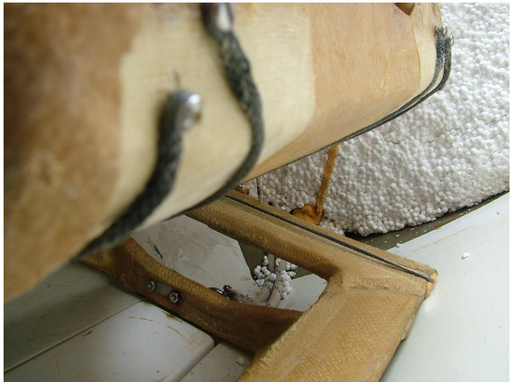
obr. 3.3 Valivé připevnění sedačky k rámu
