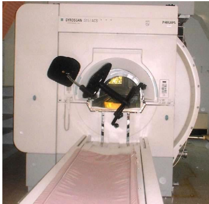
Obrázek 16: Působení MR magnetu na kancelářské křeslo [16]
