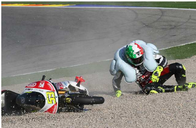
Obr. 28 - Oblečení motocyklisty s integrovaným airbagem (55)
