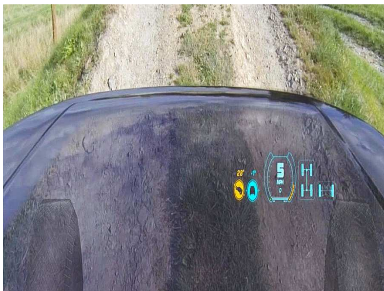
Obr. 29 – Systém průhledné kapoty (56)
