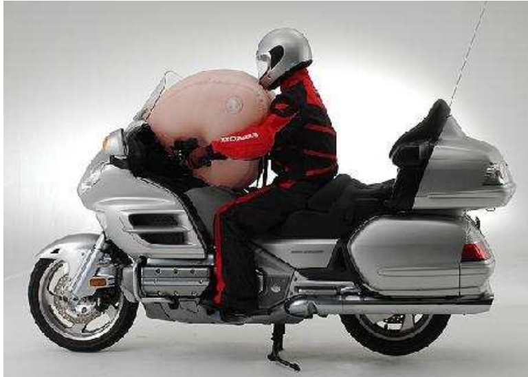
Obr. 27 - Airbag motocyklu (Honda) (54)
