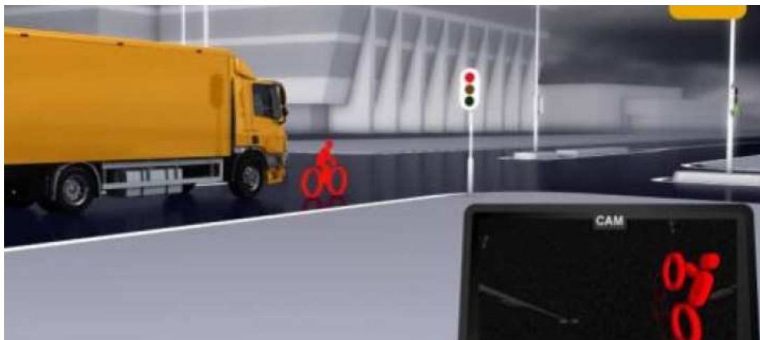
Obr. 25 – Situace, kterou řeší kamera pro přední pohled a zobrazení na displeji ve vozidle (vpravo dole) (50)
