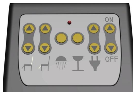
Obrázek 22 - Ovládací panel sedadla 1. třídy
