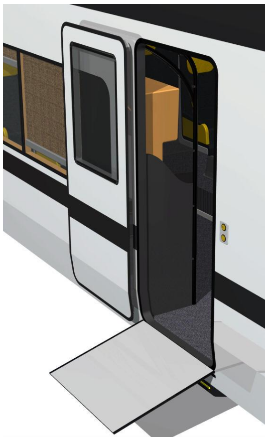
Obrázek 8 - Vysuvná plošina pro invalidní vozíky a kočárky
