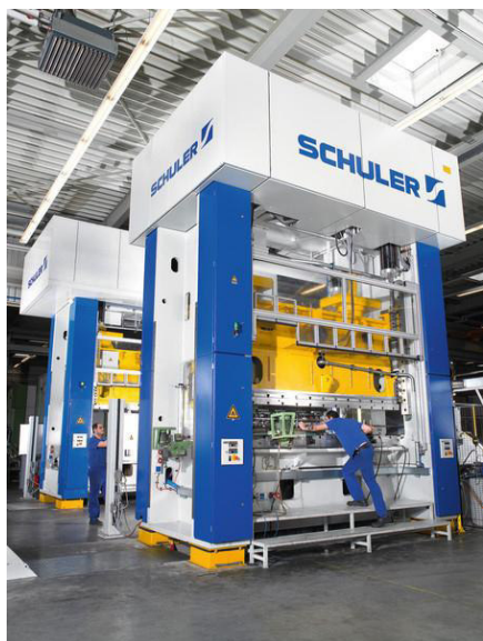
Obr. 30 MSD 250 servopress se silou 2,5MN
