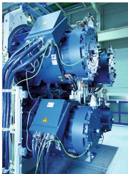
Obr. 31 Připojení čtyř motorů ServoDrive k lisu
